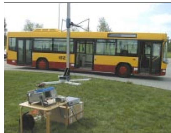
rys. 4. Pomiary emisji promieniowanej dla autobusu komunikacji miejskiej
