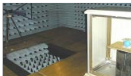
rys. 3. Pomiary skuteczności ekranowania dużych obudów w komorze bezodbiowej 1
