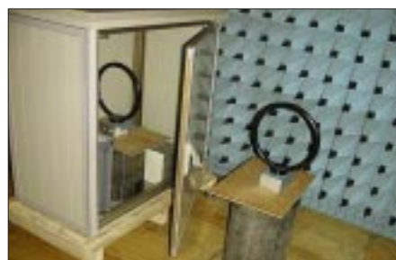
rys. 2. Pomiary skuteczności ekranowania dużych obudów w komorze bezodbiowej 1
