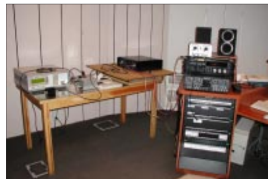
rys. 6. Badania odporności wzmacniacza akustycznego na zakłócenia radiowe indukowane w kablu zasilającym
