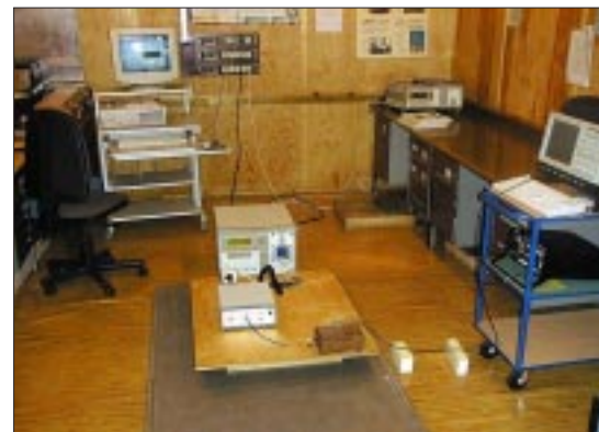
rys. 5. Test odporności na serie szybkich stanów przejściowych
